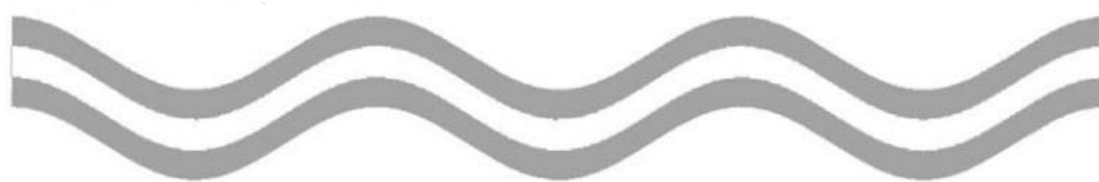
شکل ۳-۱ کانال موجی انتخاب شده براساس پژوهش قربانی و همکاران [۴۵] با طول موج ۲۵۰۰ میکرومتر و دامنه موج ۲۵۰ میکرومتر
